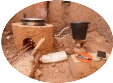
**Générateur électrique thermique (TEG) chargeant un portable à partir du Wanrou**
